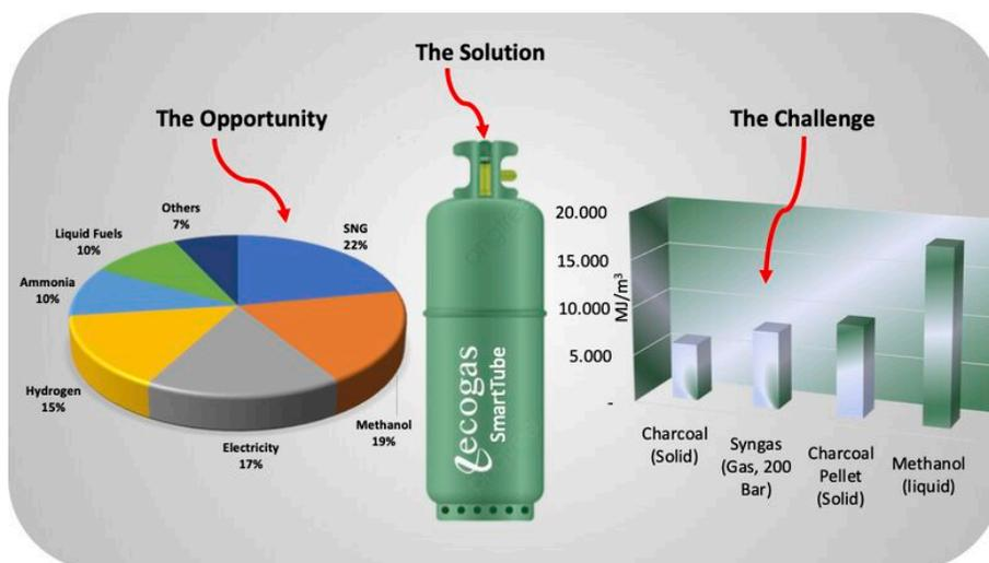
Maka inilah solusinya yang kita tawarkan, yaitu apa yang kami sebut gas on-demand. Biosyngas diproduksi secara in-situ dan in-time, di tempat dia digunakan dan saat akan digunakan. Selama dalam pengangkutan dan penyimpanannya, biosyngas 'disimpan' dalam bentuk pellet arang atau biomethanol tergantung pada penggunaan akhirnya.
