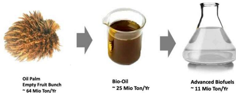
GJ/ton. Bio-oil ini sudah menjadi bahan bakar yang dikenal luas di dunia untuk mesin-mesin statis seperti power plant dsb. Bahkan sudah ada standarnya yaitu ASTM D7544.
